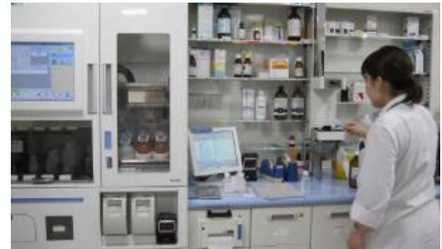
全自動水剤分注装置 水薬監査システム
